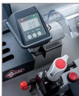
Цифровой копир с микрометрической регулировкой
